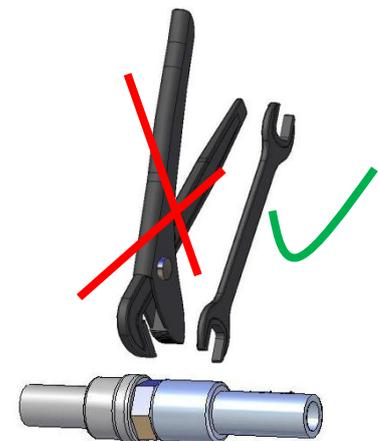
ДЛЯ ЗАТЯЖКИ ВИНТОВЫХ СОЕДИНЕНИЙ С РЕЗЬБОЙ ШЕСТИ ИЛИ ВОСЬМИГРАННЫХ ГОЛОВОК ИСПОЛЬЗУЕТСЯ НАТЯЖНОЙ КЛЮЧ
