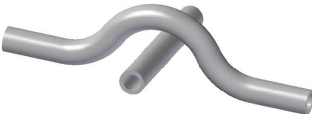
ПЕРЕКРЕСТНАЯ ПРОКЛАДКА ТРУБОПРОВОДОВ ВЫПОЛНЯЕТСЯ С ИСПОЛЬЗОВАНИЕМ СПЕЦИАЛЬНЫХ ЭЛЕМЕНТОВ, СПЕЦИАЛЬНО ПРЕДНАЗНАЧЕННЫХ ДЛЯ ЭТИХ ЦЕЛЕЙ
