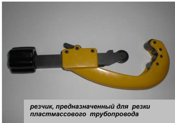
*резчик, предназначенный для резки
